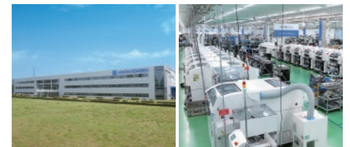
富岡生産センター「MIRAI」 直線的に配置された滞留のない生産ライン
