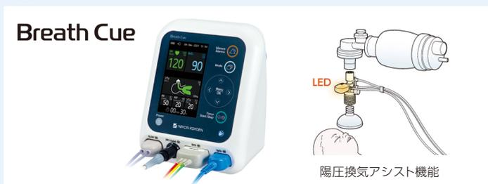
新生児蘇生モニタは、心電図やSpO<sub>2</sub>、呼吸流量、気道内圧といった、新生児蘇生に特化したパラメータをモニタリングする当社初の製品です。新生児が仮死状態で出生する割合は約15%<sup>\*1</sup>と言われており、多くが呼吸不全の状態にあります。新生児蘇生においては、呼吸を補助するために手動での陽圧換気<sup>\*2</sup>が行われますが、本製品はLEDの色と点滅で陽圧換気を視覚的にサポートします。本製品の普及を通じて、インドネシアなど新興国における新生児蘇生法をサポートし、死亡率や重篤な後遺症の低減を目指します。SDGsにおいても新生児死亡率の低減が掲げられており、サステナビリティ推進の一環として普及に取り組みます。
